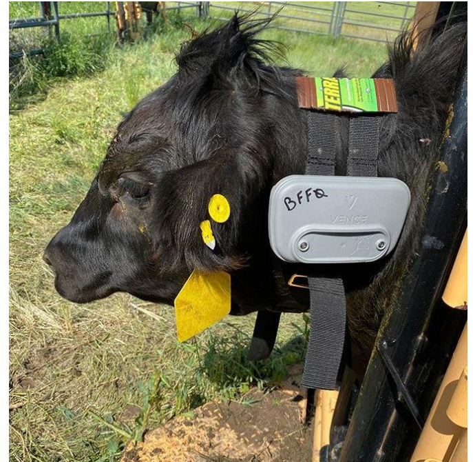
Εικόνα 22: Βοειδή εξοπλισμένα με γιακά εικονικού φράχτη (παραπομπή 13)
